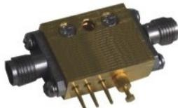
产品涵盖单刀单掷、单刀多掷的各种反射式、吸收式开关。分段频率范围覆盖1~18000MHz，关断隔离度60dB，插损≤1.5dB
